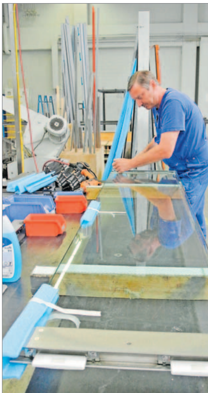
Auch das Einglasen von Aufzugtüren bei Schmitt + Sohn noch selbst gemacht.
