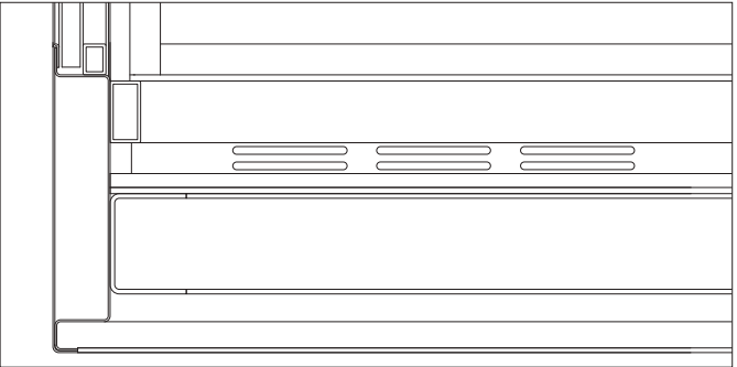
Vertikalschnitt Rückwand / Boden. Sockelleiste. Verdeckte, großzügig bemessene Kabinenbelüftung unter der Sockelleiste.
