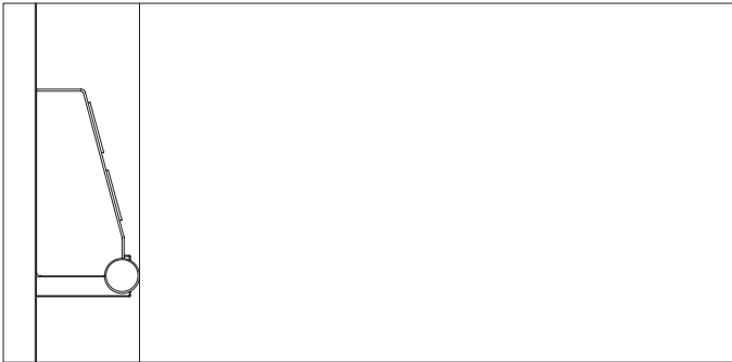
Vertikalschnitt Seitenwand, Bedientableau EN 81-70-B.
